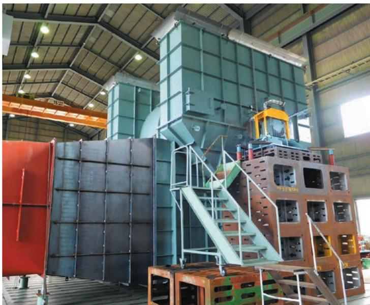
製造時に出る大量の粉塵を吸い取る、建屋用集塵ファン。ダクトなどの周辺設備に手を加えることなく、送風機だけの入れ替えが可能だという
